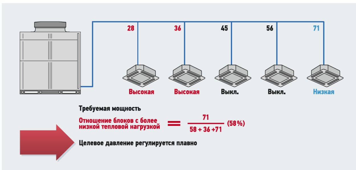
❖ Рис. 7. Оценка требуемой мощности наружным блоком в режиме частичной загрузки
