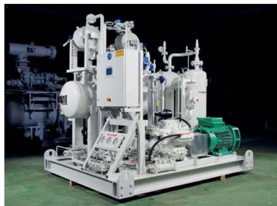
Рисунок 2: Аммиачный тепловой насос с поршневым компрессором
