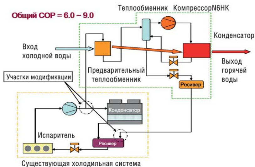
Рисунок 3: Принципиальная схема установки мясокombината
