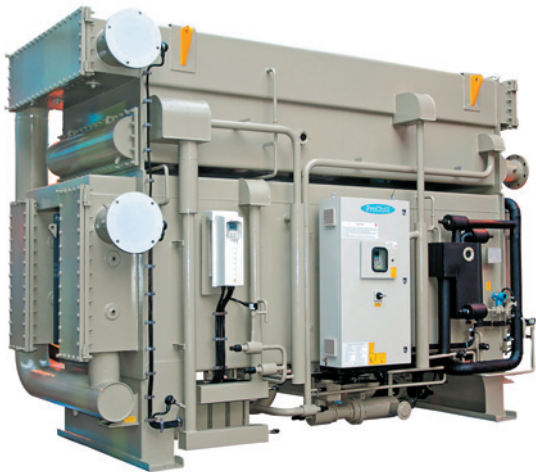
Рис. 1. АБХМ Thermax на горячей воде используются для комфортного и промышленного холодоснабжения. Обычно они используются там, где имеется источник горячей воды (котельная или горячая вода от технологических процессов). Мощность – 35...7 000 кВт. Температура греющей воды – 75...200°С, холодной воды – минимум 0°С
