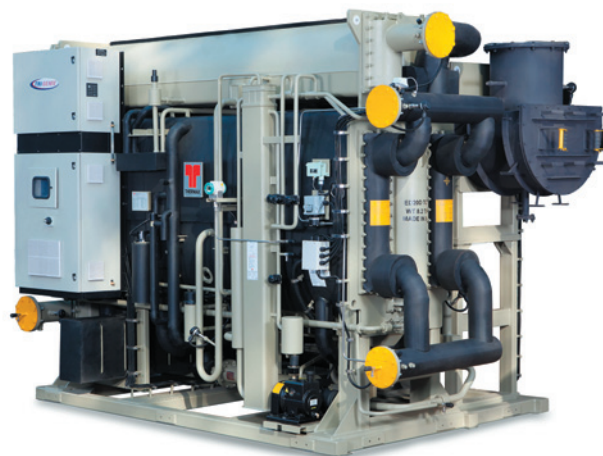
Рис. 3. АБХМ Thermax на выхлопных газах. Идеально подходят для объектов с газотурбинными установками, позволяют для выработки холода утилизировать теплоту выхлопные газов газовых турбин, когенерационных установок, генераторов. Мощность – 180...7 000 кВт. Температура холодной воды – минимум 0°С
