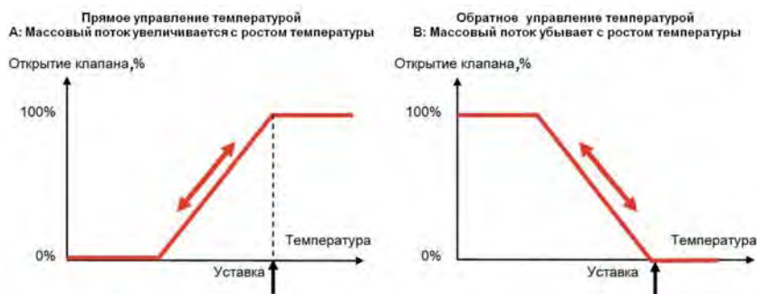
Рис. 3. Работа EXD-SH1/2 в качестве контроллера температуры
