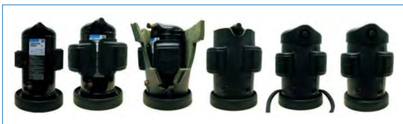
Рис. 2. Пошаговая сборка шумозащитного кожуха спирального компрессора
