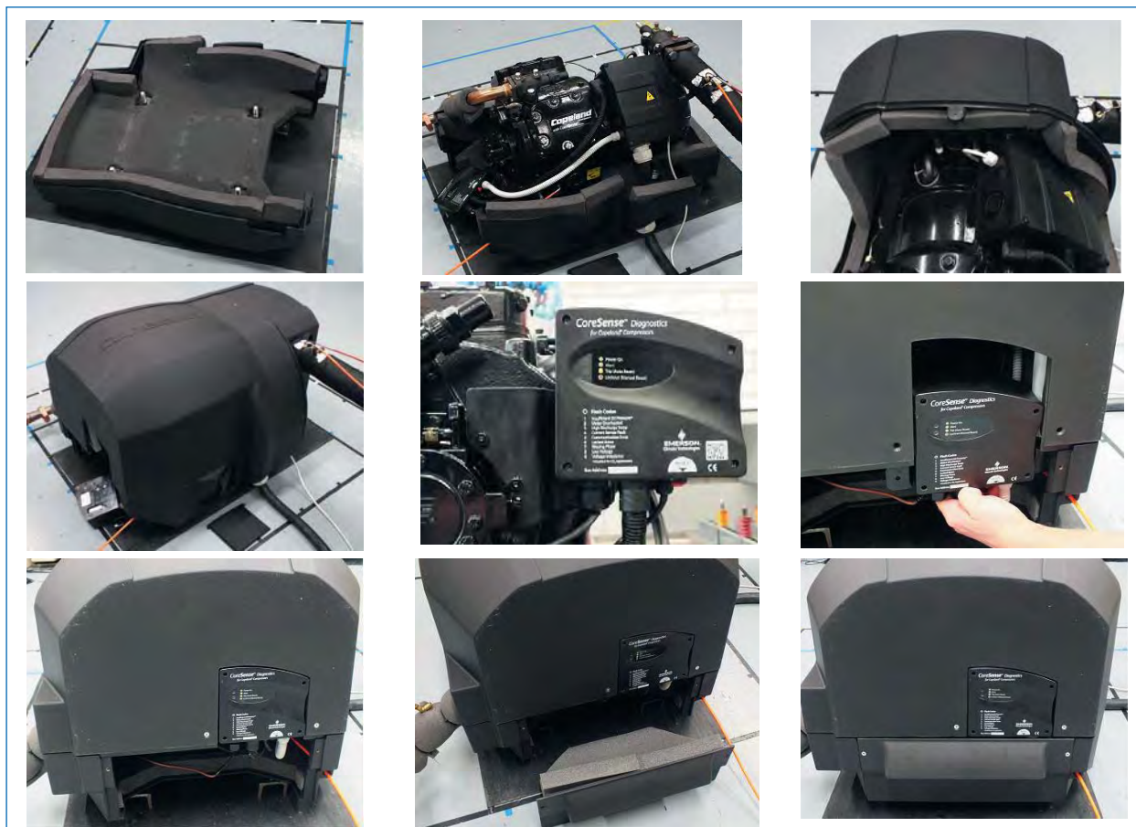
Рис. 5. Пошаговая сборка шумозащитного кожуха компрессора Stream
