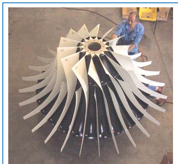
Рис. 3. Колесо центробежного турбокомпрессора с лопатками из углепластика
