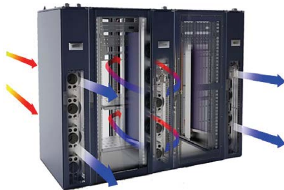
Рис. 4. Внутрирядные кондиционеры забирают воздух из горячего коридора и выдувают охлажденный воздух прямо в холодный коридор ЦОД
