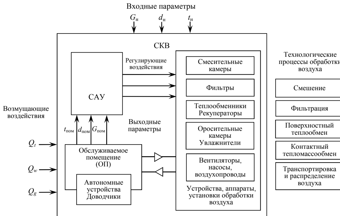
Рис. 2. Общая структурная схема СКВ как предмета автоматизации: t_{пом} , d_{пом} , G_{пом} – температура, влажность, расход воздуха в помещении; t_n , d_n , G_n – температура, влажность, расход воздуха; Q_t , Q_w , Q_g – тепловое, влажностное и газовое воздействие
